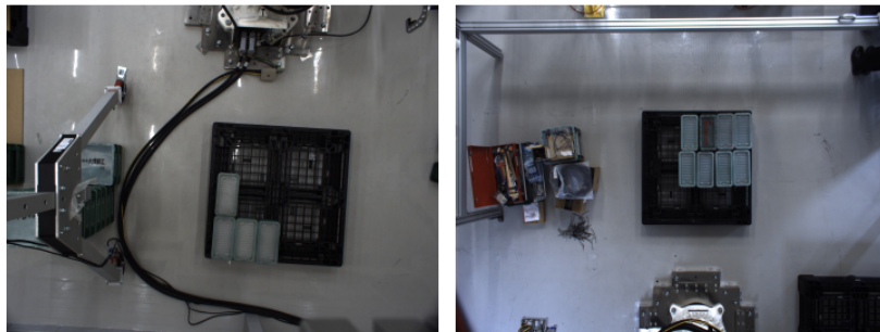
错误示例：训练数据高度（图左）与实际应用高度（图右）不一致
