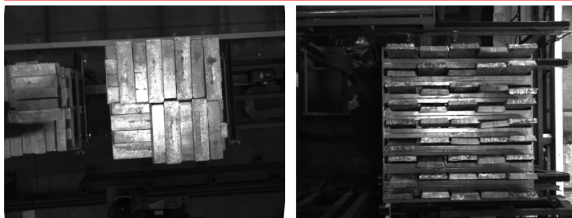
错误示例：训练数据视野（图左）与实际应用视野（图右）不一致
