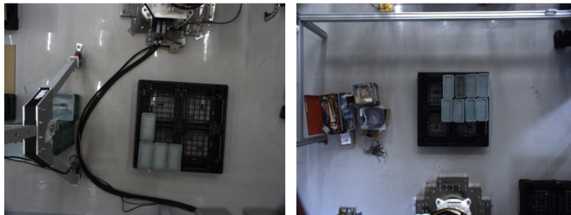
错误示例：训练数据高度（图左）与实际应用高度（图右）不一致
