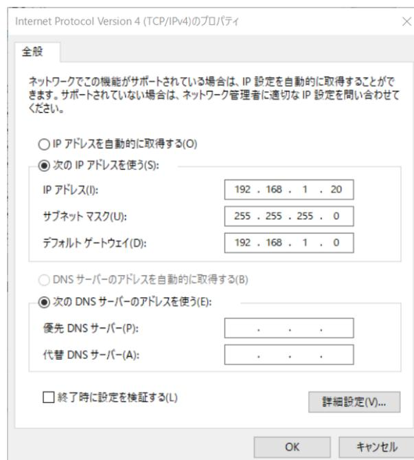
6. 手順2~5を繰り返し、ロボットコントローラが接続されているLANポートの名前を変更し（例：To\_robot）、LANポートのIPアドレスを設定します。例えば、LANポートのIPアドレスは「192.168.200.10」です。
