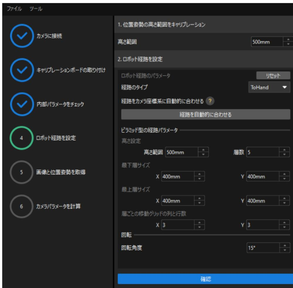
2. 実際の状況に応じて、**経路のタイプ**をToHandに指定し、ピラミッド型の経路パラメータ下の**高さ範囲**、**層数**、**最下層サイズX/Y**、**最上層サイズX/Y**と**層ごとの移動グリッドの列と行数**を設定し、**回転角度**を設定してから、**[確認]**をクリックします。
