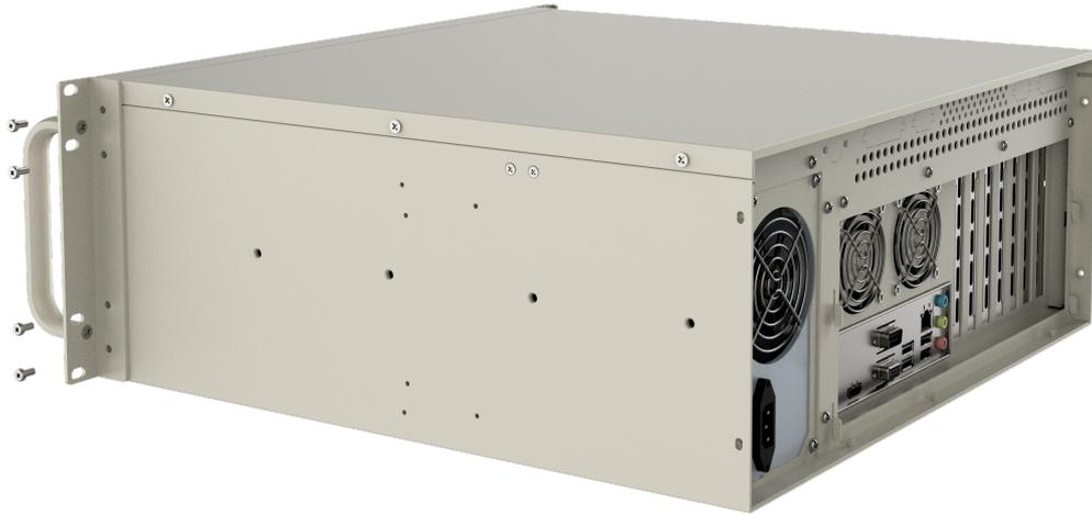
3. 引き手の前面にある取り付け穴を、ラック上の取り付け穴に合わせます。
