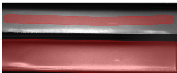
間違った例：2つのラベル付け方法で同じ欠陥にラベルを付ける
