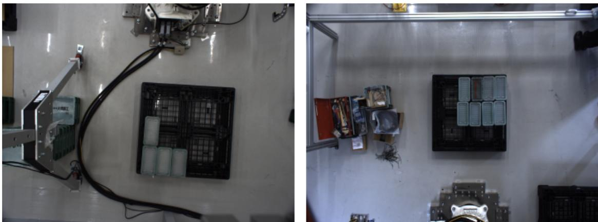
対策：トレーニングデータを取得したカメラの高さを実際応用中のカメラの高さと一致させてください。
