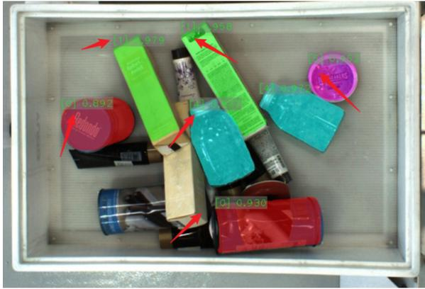
右図のワークに対して「インスタンスセグメンテーション」モジュールを使用してワークを一個ずつ認識し、ワークの形状やパターンなどによって「対象物検出」モジュールを使用してワークの向きを判断します。（下図の左はインスタンスセグメンテーションの結果で、右は対象物検出で向き判定の結果です）
