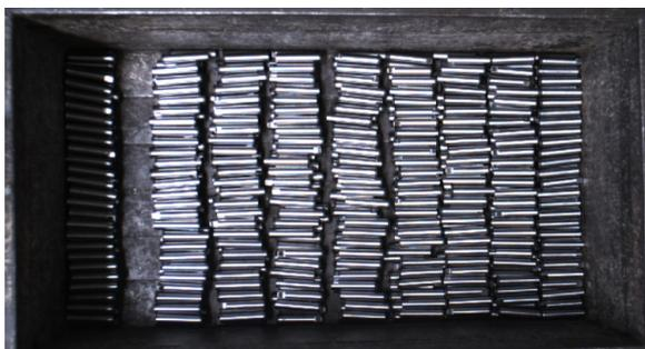
2. 点群：光沢があるため点群のロスが発生しました。ワークの軸方向の点群がロスします。
