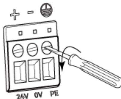
2. Inserte los alambres en los terminales correspondientes. Inserte el alambre positivo en el terminal de 24V, el alambre negativo en el terminal de 0V y el de tierra en el terminal de PE(⊕).
