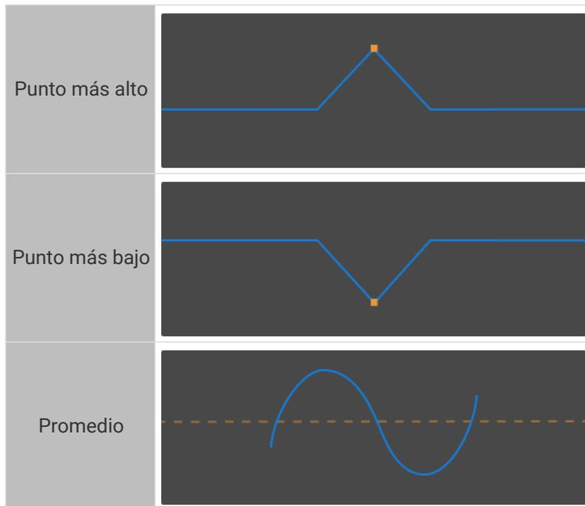
Durante la medición, es necesario establecer las posiciones y anchuras adecuadas de las áreas de detección para asegurarse de que se puedan detectar todos los puntos correctos.
