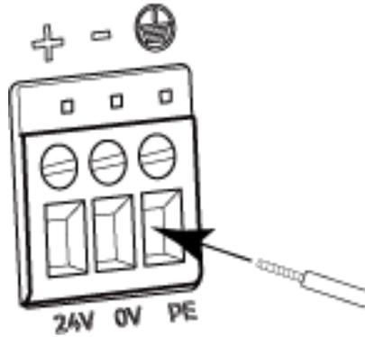
3. Use el destornillador plano para apretar los tornillos sobre los terminales de alimentación. La torsión de apriete recomendada es 0,2 N·m.
