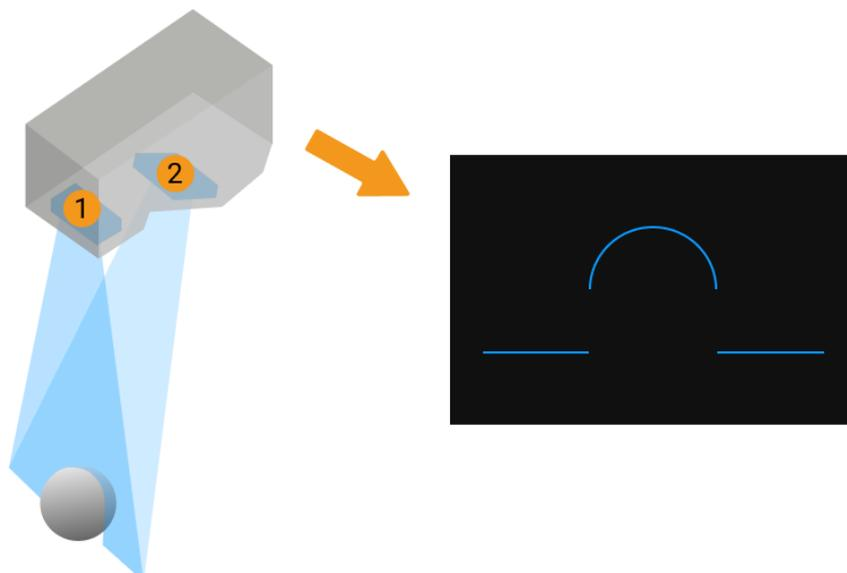
1. El emisor láser (1 en la figura de arriba) emite una línea de luz láser en la superficie del objeto de destino dentro del FOV del perfilador láser.
