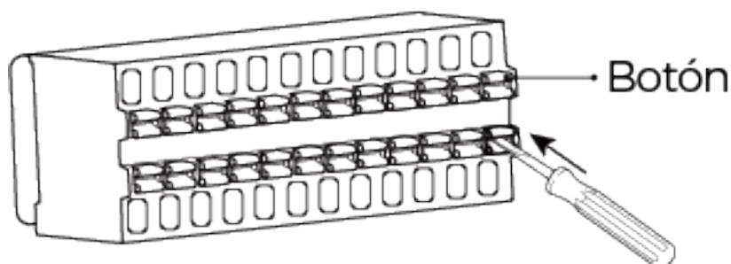
2. Inserte el alambre en el terminal y retire el destornillador plano.
