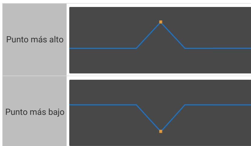
Durante la medición, es necesario establecer las posiciones y anchuras adecuadas de las áreas de detección para asegurarse de que se puedan detectar todos los puntos correctos.
