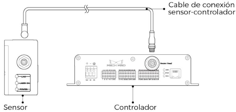
1. Al insertar los conectores del cable de conexión de sensor-controlador, alinee la protuberancia del conector con la muesca del puerto.
