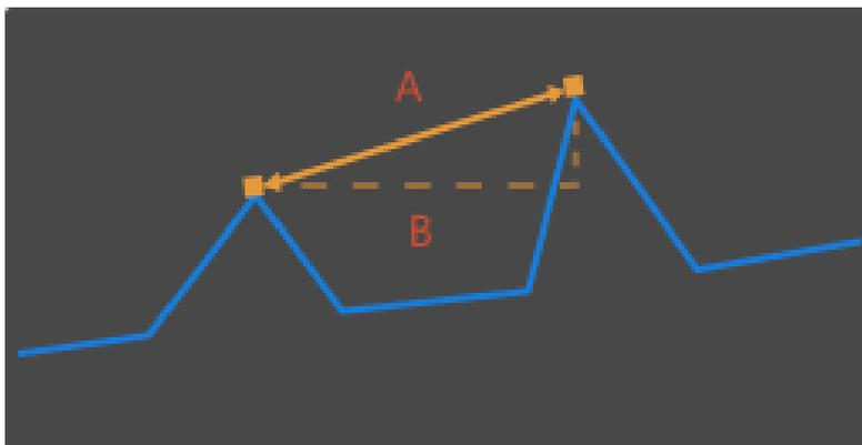
9. Revise el resultado de medición de la distancia entre los dos puntos en **Resultado de medición**, ubicado en la parte inferior del panel derecho. Si el resultado de medición no es preciso o no se visualiza, ajuste de nuevo las posiciones y anchuras de las áreas de detección.
