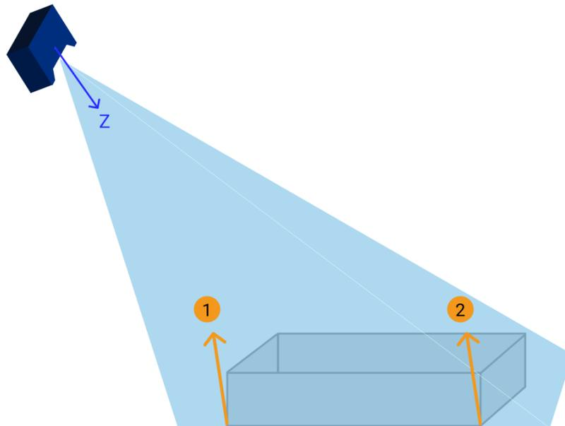
En la figura arriba, los puntos ① y ② están a la misma altura del punto de vista de un observador. Sin embargo, el eje Z no está perpendicular al plano donde está el objeto, los valores de profundidad de los dos puntos se difieren en el mapa de profundidad y la nube de puntos obtenidos.
