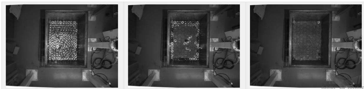
3. 某金属件项目，多层整齐码放，采集 30 张。物体朝向方面，只需考虑正面向上摆放。物体位置方面，需考虑到位于料筐中央、四周、边角以及高、中、低层不同高度的情况。物体间关系方面，需考虑紧密贴合等，实际采集图片如下：
