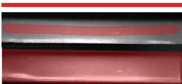
正确示例：用一种标注方式标注同一种缺陷。
