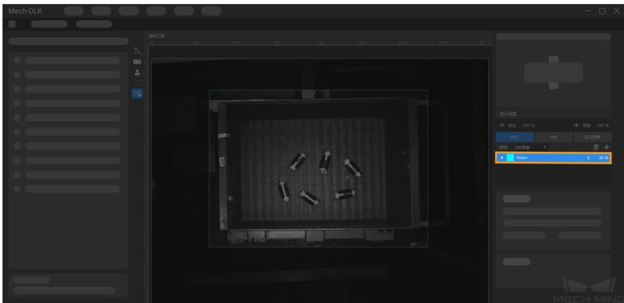
6. 标注图像：以矩形框标注出图像中所有转子。标注时尽量矩形框刚好包住转子边缘，避免过多标注转子边缘以外的区域，标注不准确会影响模型训练效果。
