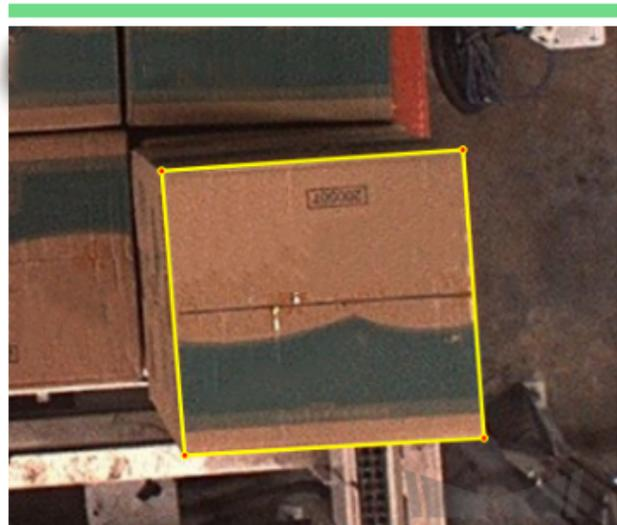
2. **标注完整外轮廓：**适用于麻袋、各类工件等，标注完整外轮廓是通用的标注方式。
