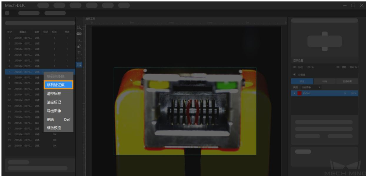
6. 训练模型：使用默认参数设定，点击 训练开始训练模型。
