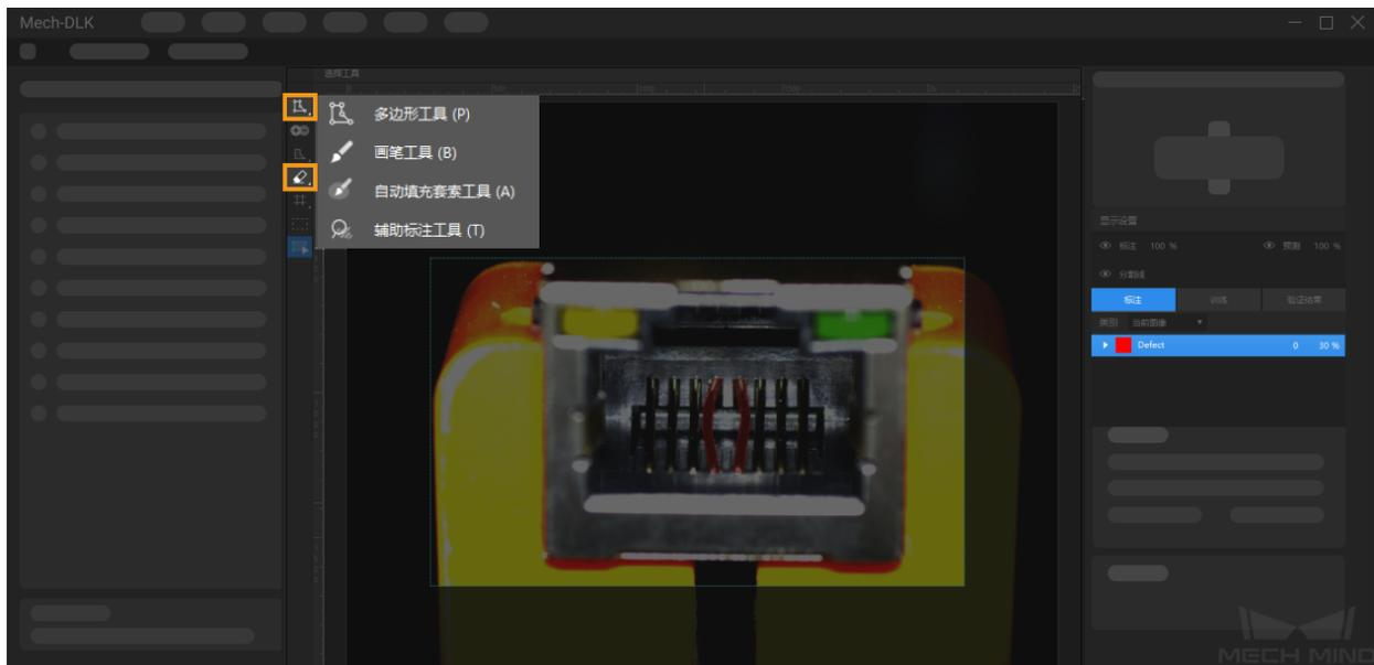
对于 OK 图像，请在左侧图像列表中选中无缺陷的图像，单击鼠标右键选择 设置为 OK。请确保训练集中至少有一张图像标注为 OK。
