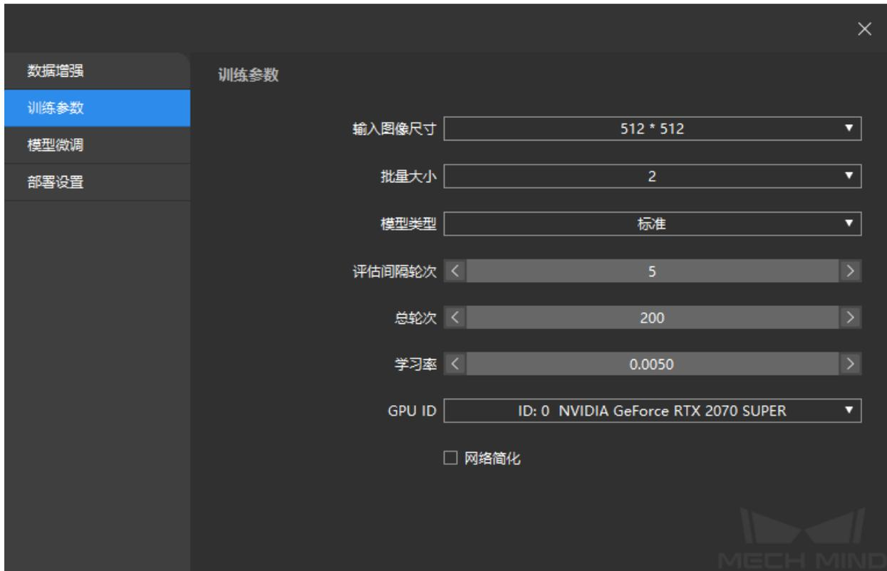
**输入图像尺寸** 训练时输入神经网络的图像宽高（单位：像素）。建议使用默认设定；若图像中的物体或标注缺陷区域较小时，需要适当调大 **输入图像尺寸**。图像尺寸越大，模型精度越高，但是训练速度越低。
