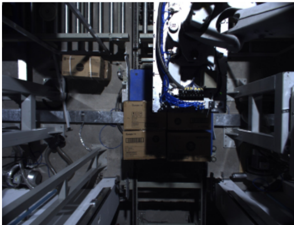
間違った例：ロボットアームがカメラの視野を遮る
