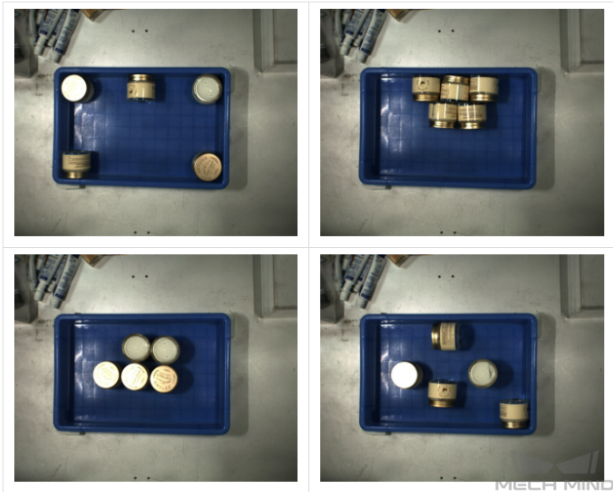
피킹 용기 모서리에 배치되는 경우 (왼쪽 상단) & 긴밀하게 이어지는 경우 (오른쪽 상단) & 밀착하게 붙여 있는 경우 (왼쪽 하단) & 소량 물체가 어지럽게 흩어지는 경우 (오른쪽 하단)
