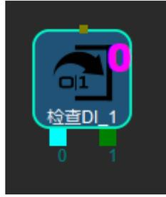
设置为 1 时，信号将由端口 1 输出，并将该步骤之前和之后的步骤连起来共同规划，使机器人整体运行更为流畅。
