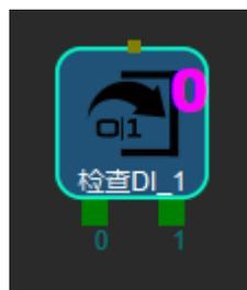
设置为 0 时，信号将由端口 0 输出，并将该步骤之前和之后的步骤连起来共同规划，使机器人整体运行更为流畅。
