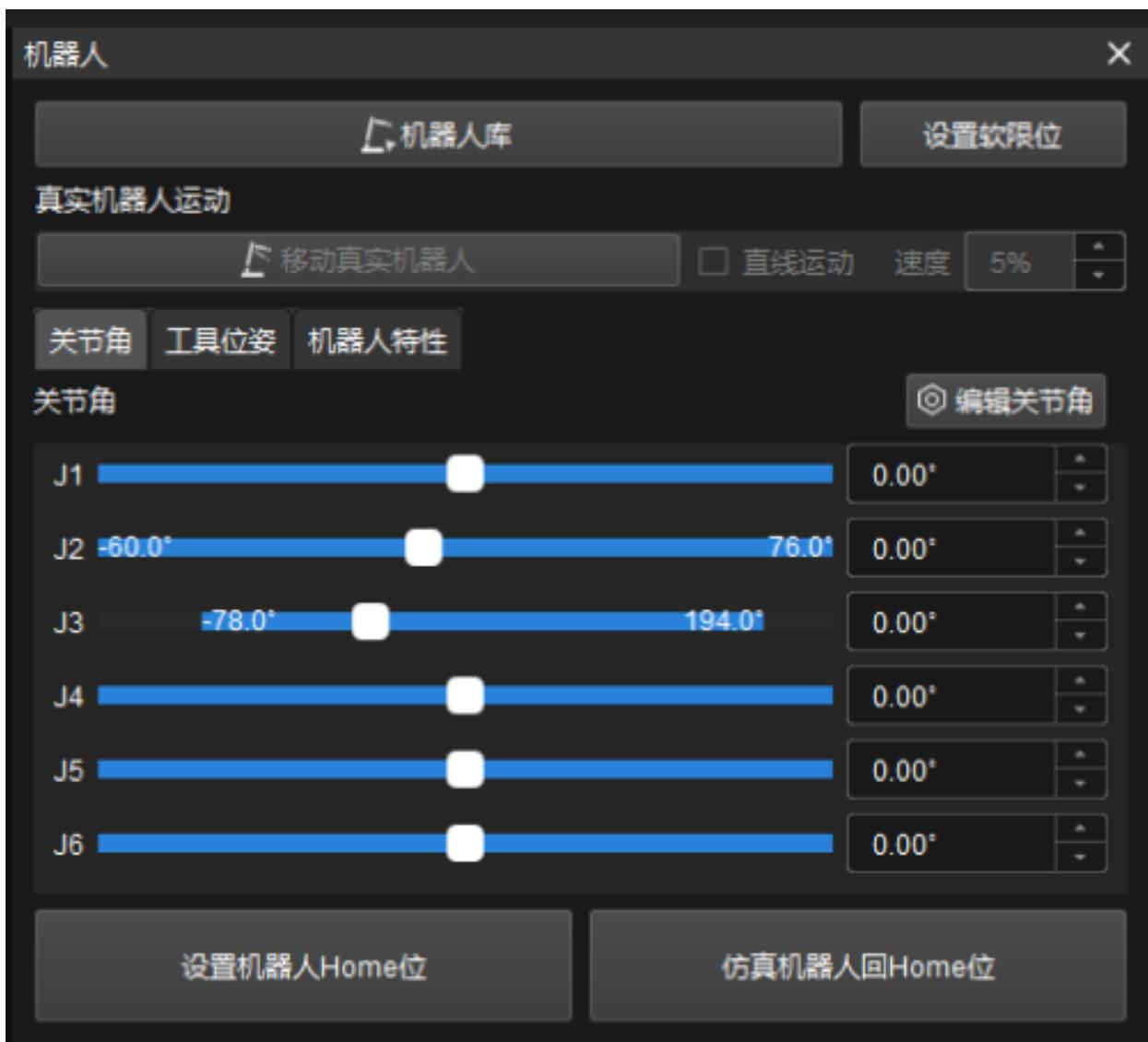
在机器人功能面板中可更换机器人模型、设置机器人软限位、移动真实机器人、调整机器人位姿、设置机器人 Home 位等，详细操作说明请参阅机器人配置。
