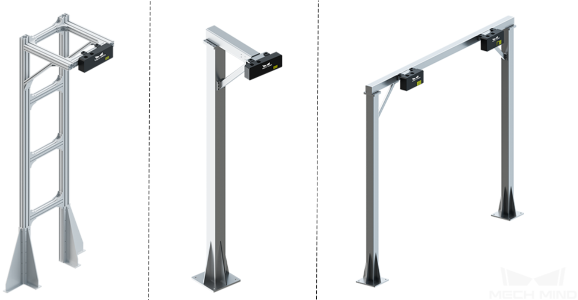
그림 5 왼쪽: 임시 카메라 스탠드, 중간: 철골 구조 스탠드, 오른쪽: 갠트리
