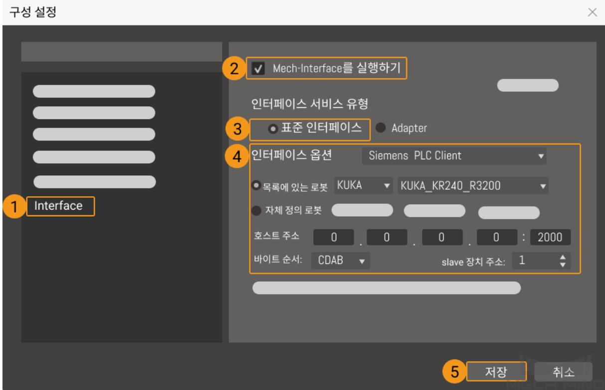
**답:** 마스터의 부동 소수점 비트 순서 요구 사항에 따라 비트 순서를 설정합니다. 예를 들어 표준 빅 엔디안 데이터의 경우 DCBA 를 선택하고 표준 리틀 엔디안 데이터의 경우 ABCD 를 선택합니다.
