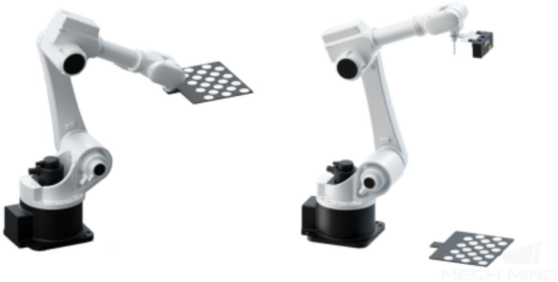
그림 1 캘리브레이션 보드 설치 및 세팅
