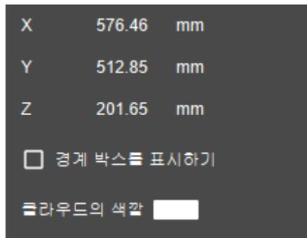
2. CAD 파일을 선택한 경우 해당 CAD 모델 경계 박스의 크기를 표시하고 **경계 박스를 표시하기** 온셋이 나타날 것입니다.
